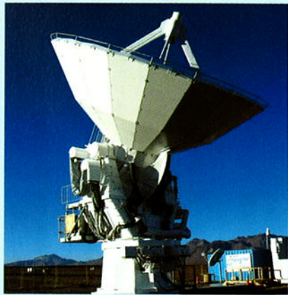
アステ望遠鏡。作業は望遠鏡サイトで。観測は標高の低い麓から衛星通信を介した遠隔操作。奥に見える青いコンテナとアンテナが通信インフラ。
